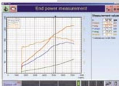
La funzione del cursore permette la valutazione ottimale del diagramma di prova. I dati misurati vengono indicati in modo digitale nella posizione del cursore.
